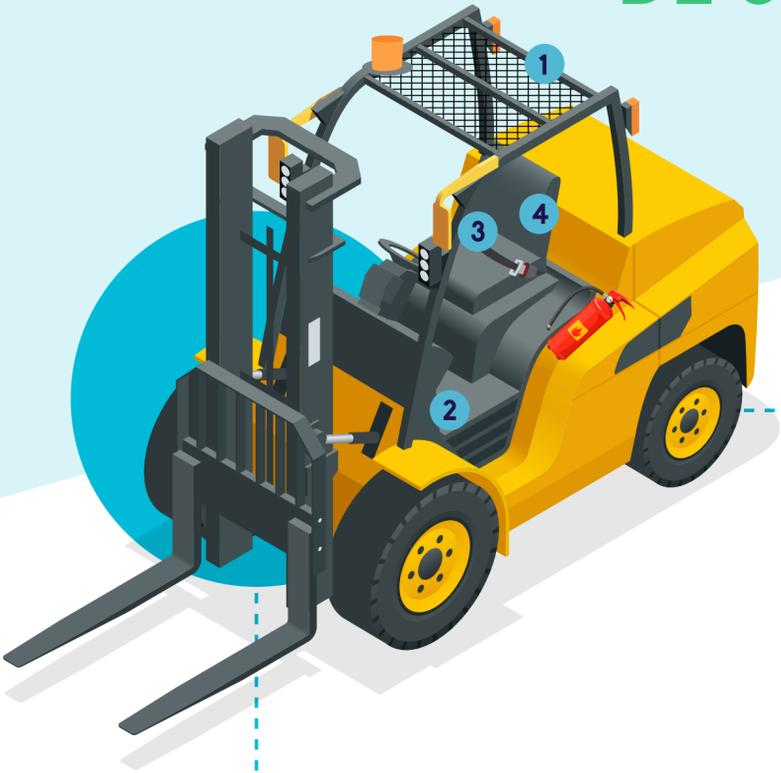
+ Todas las carretillas deben cumplir con una serie de elementos de seguridad y estar acondicionadas para limitar los riesgos de vuelco y para proteger al conductor u ocupantes de la carretilla de los riesgos de atrapamiento en caso de vuelco.
